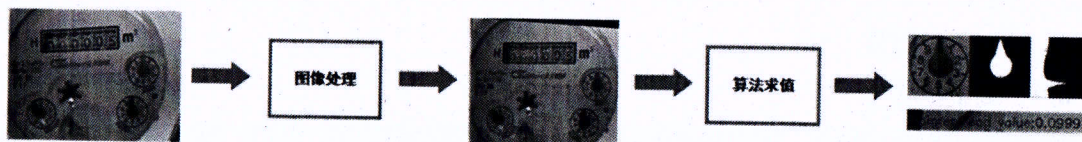
图5 机械水表指针读数自动识别步骤示意图
